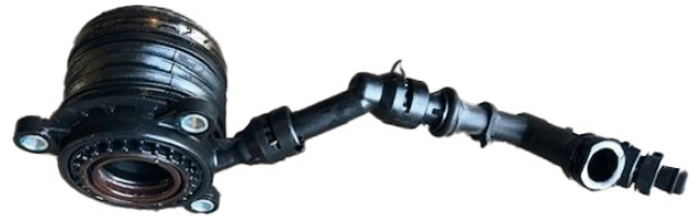
Imagen 1: Conducto hidráulico del CSC de plástico
