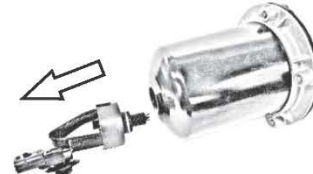
2. Extraire le capteur de la cloche.
