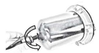
14. Visser le capteur dans la cloche.
