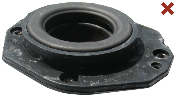
Fig. 1: Montage incorrect du palier support jambes de suspension
