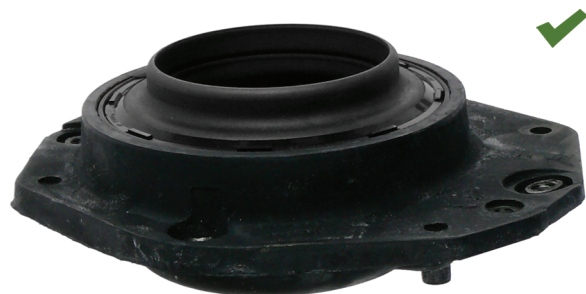
Fig. 2: Cojinete de apoyo del tubo amortiguador correctamente montado
