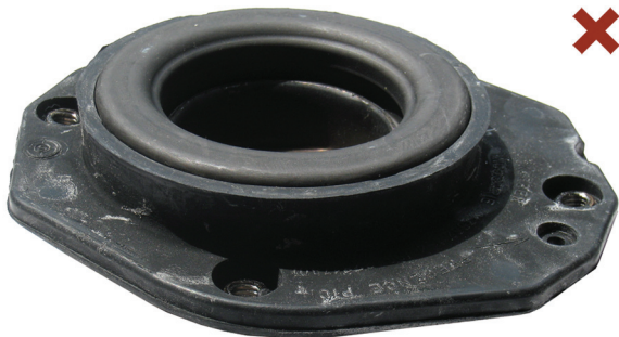
Fig. 1: Cojinete de apoyo del tubo amortiguador mal montado
