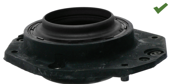
Fig. 2: Fjederbensleje monteret korrekt
