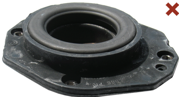
Fig. 1: Fjederbensleje monteret forkert
