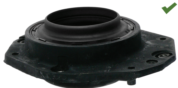
Fig. 2: Oikein asennettu joustintuen tukilaakeri
