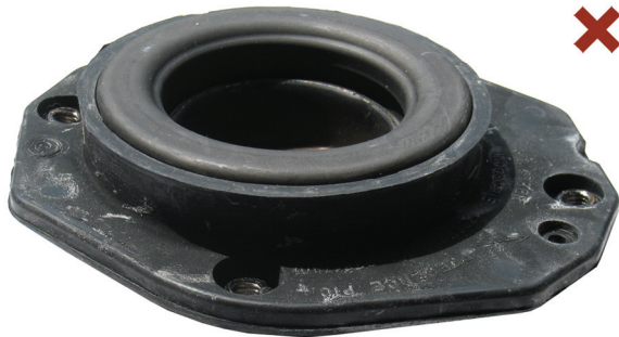
Fig. 1: Väärin asennettu joustintuen tukilaakeri
