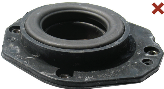
Fig. 1: Hibásan beszerelt toronycsapágó
