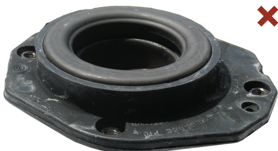
Fig. 1: Apoio superior do amortecedor montado incorrectamente
