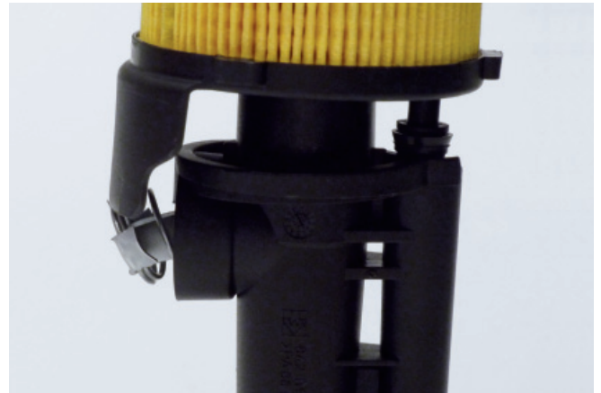
Figure 4: Vista en detalle de los daños derivados que se han producido en la válvula bypass.
