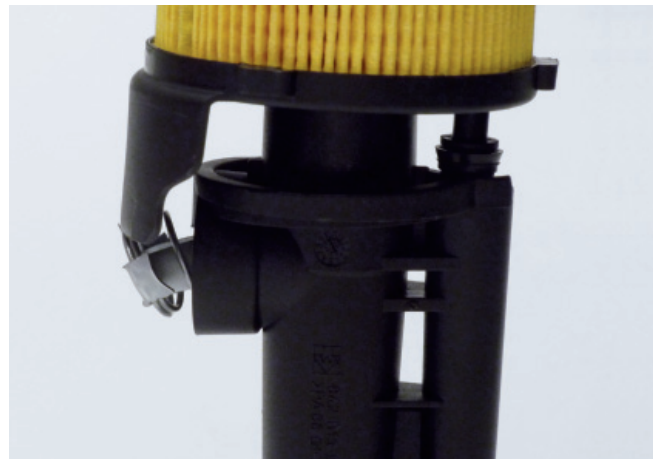
Рисунок 4: Увеличенное изображение поврежденного перепускного клапана.
