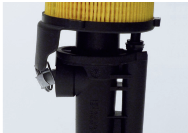
Ilustracja 4: Widok szczegółowy uszkodzonego w konsekwencji zaworu obejściowego.
