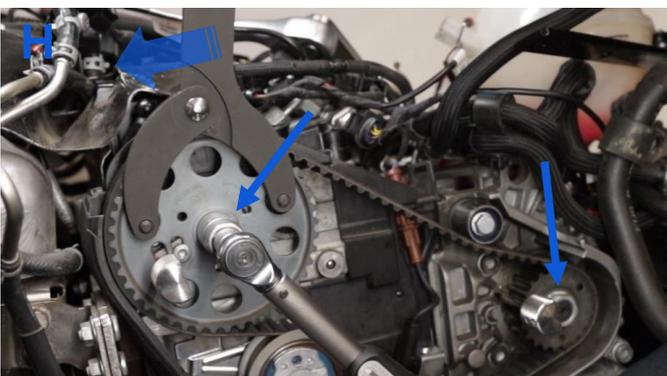
6. Coloque el soporte de fijación del árbol de levas en el piñón del árbol de levas como se muestra. Presione el soporte de fijación en el sentido contrario a las agujas del reloj y sujételo. Ahora apriete el tornillo de fijación del piñón del árbol de levas y el piñón de la bomba de alta presión a 20 Nm.
