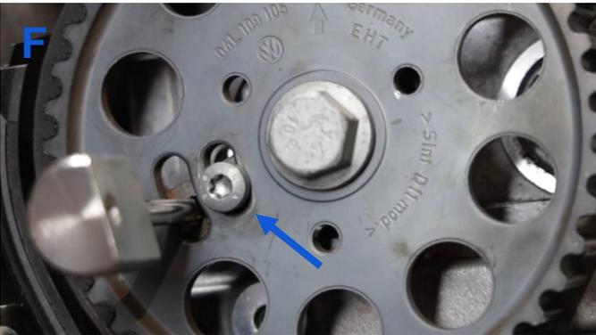
4. Afloje la tuerca del tensor y retire la herramienta T10265. Compruebe de nuevo que la polea tensora está correctamente asentada (fig. C) y asegúrese que el tornillo de fijación de la rueda dentada del cigüeñal está en el tercio inferior de la ranura.
