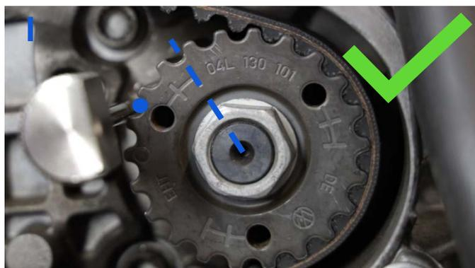
7. Il pignone della pompa ad alta pressione ha un campo di rotazione limitato. È essenziale verificare che il pignone non sia completamente fermo dopo il tensionamento. Verificare che la marcatura sulla ruota dentata ad alta pressione non sia allineata con il perno. Se necessario, correggere la posizione del pignone della pompa ad alta pressione di un dente in senso orario e reinstallare la cinghia di distribuzione.
