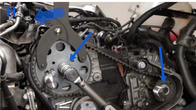
6. Posizionare il controsupporto dell'albero a camme sulla ruota dentata dell'albero a camme come illustrato. Premere il controsupporto in senso antiorario e tenerlo fermo. Ora serrare la vite di fissaggio della ruota dentata dell'albero a camme e della ruota dentata della pompa ad alta pressione con 20 Nm.
