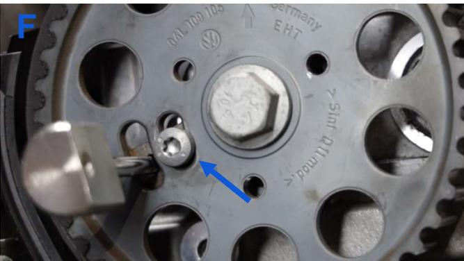
4. Allentare il dado del tenditore e rimuovere l'utensile T10265. Verificare nuovamente che la puleggia tenditrice sia correttamente inserita (Fig. C) e che la vite di fissaggio del pignone dell'albero motore si trovi nel terzo inferiore della scanalatura.
