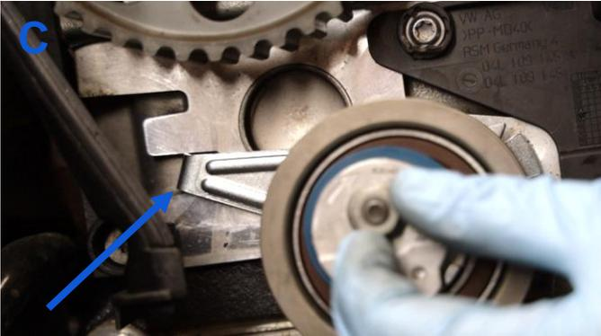
1. Tensor bloqueado com a ferramenta T10265 e fixado com porca. A ponta metálica da placa traseira do tensor deve encaixar na ranhura da cabeça de motor.
