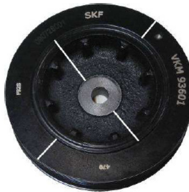
Slidt spjæld! Skal udskiftes!
