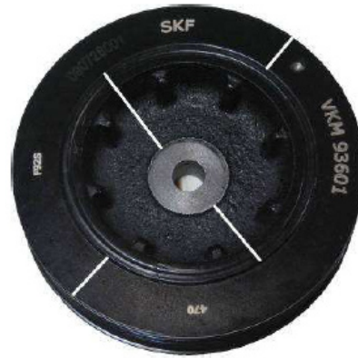
Sliten dämpare! Behöver bytas!
