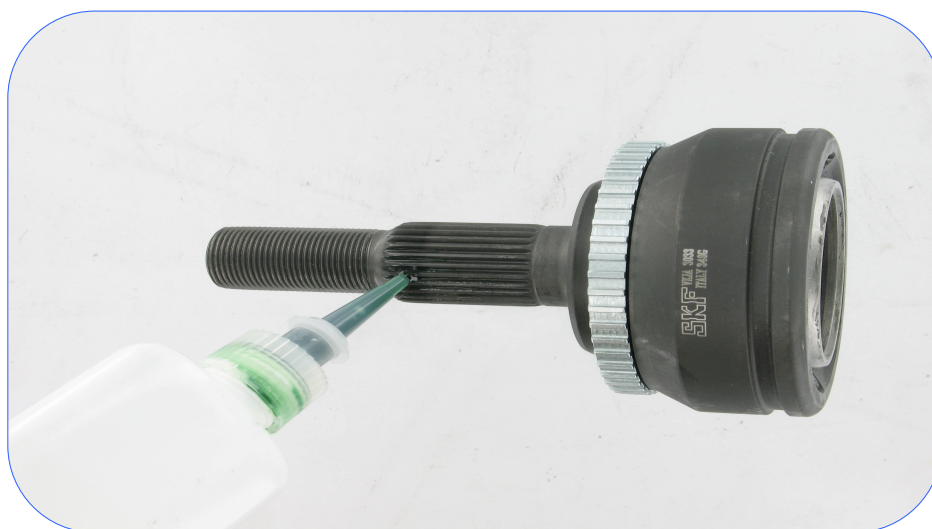
Afbeelding 1: aanbrengen van metaallijm
