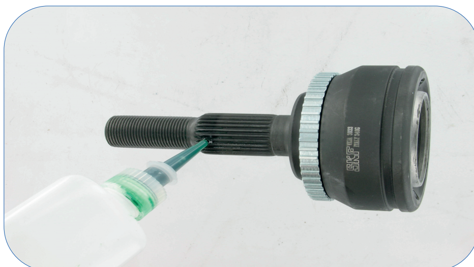
Bilde 1: Påføring av metallim
