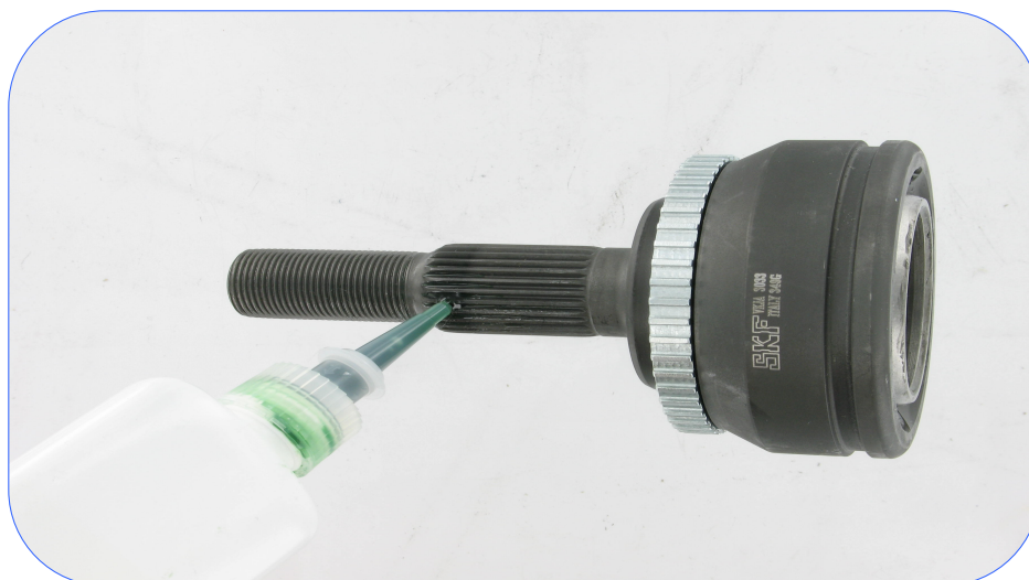
Imagem 1: Aplicação da cola para metal
