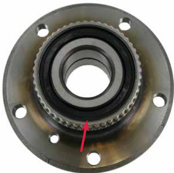
A/M kialakítás – Gumi tömítés
