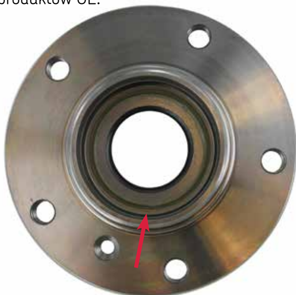
Łożysko aftermarketowe – z zewnętrznym uszczelniaczem
