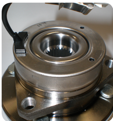
Τύπος σχεδίου 1 VKBA 3937 τοποθέτηση OK
