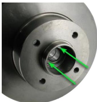
Al instalar el rodamiento y el disco de freno, aplique la fuerza SOLAMENTE en el anillo interior del rodamiento.
