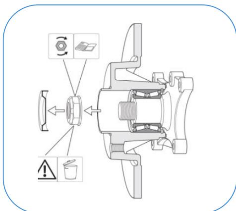
Desmontar el disco de freno de rueda, la tuerca y la tapa de montaje viejos. Nunca vuelva a usar la tuerca y la tapa antiguas.
