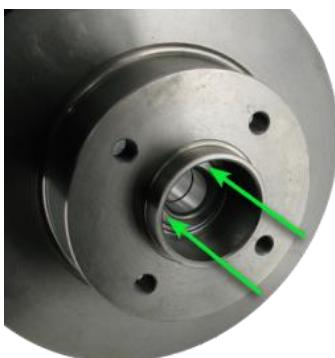
Tijekom montaže ležaja i kočionog diska primjenite silu SAMO na unutarnje prstene ležaja.
