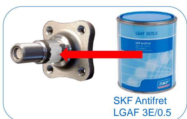
Očistiti dosjede ležaja nad ečistoća i korozije. Da biste izbjegli pojavu korozije nakon montaže, dosjed osovine uvijek premažite SKF Antifret (LGAF 3E/0.5) pastom.
