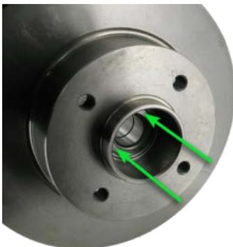
Quando si monta il cuscinetto ed il disco freno, applicare la forza solo sull'anello interno del cuscinetto.
