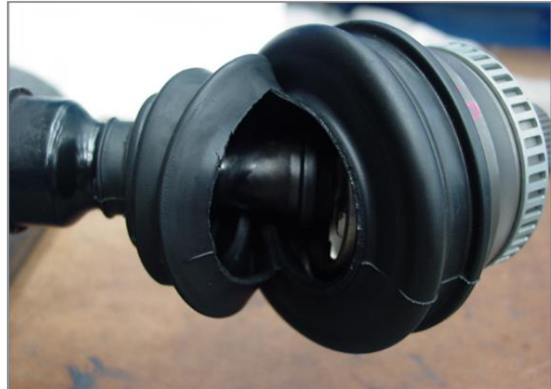
Image. 2 – Déchirure du soufflet causée par un positionnement de serrage incorrect.
