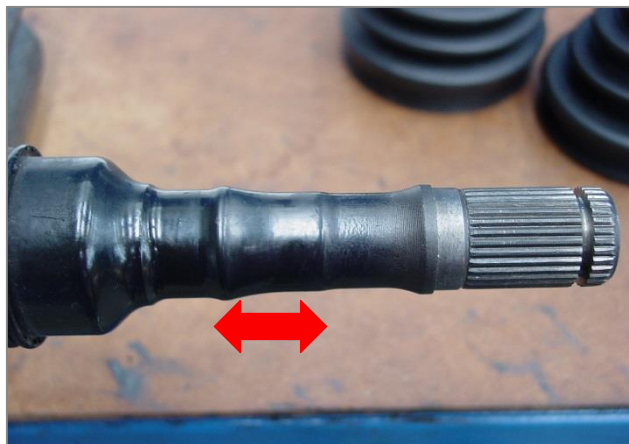
Image. 4 – Zone de positionnement correcte du soufflet .
