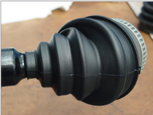
Image. 1 – Position de serrage du soufflet incorrecte
