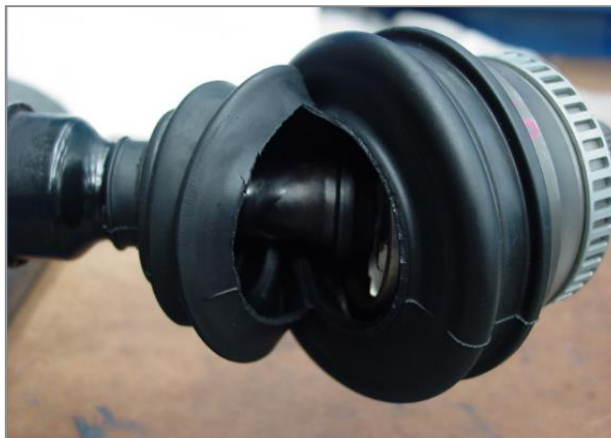
Fotografija 2 – Puknuća uslijed nepravilnog postavljanja
