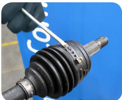
2. Coloque la transmisión en un torno (con mordazas protectoras o de aluminio).
