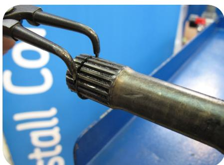
6. Expanda el anillo de retención y extráigalo con la ayuda de unos alicates de extracción para este tipo de anillos.
