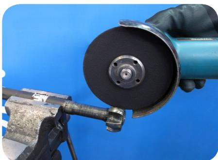
4. Corte os trilhos do canal interno, em 2 ou 3 pontos, utilizando uma ferramenta de corte adequada.
