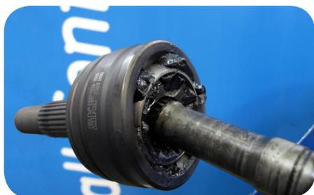
3. Pressione a nova junta homocinética contra o eixo. Com um martelo de borracha, bata até a mola de retenção ficar bloqueada na respectiva ranhura, no canal interno da junta homocinética.
