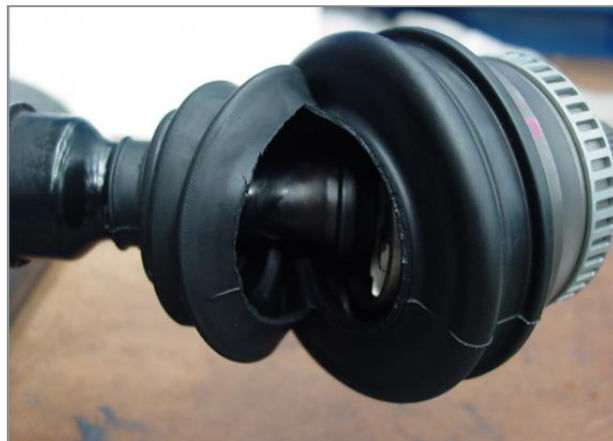
Pic. 2 – Rottura della cuffia a causa di un errato serraggio
