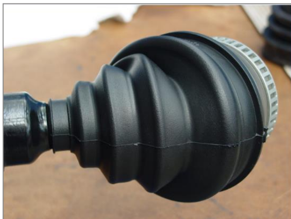
Pic. 1 – Incorretto serraggio della cuffia
