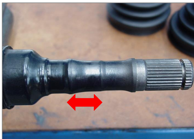
Pic. 4 – Posizione per un corretto montaggio della cuffia
