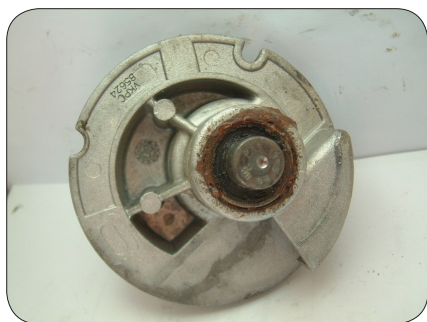
Exemples d'une pompe à eau endommagée :
