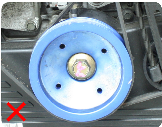
Pulegge dell'albero motore aftermarket e pulegge ammortizzate OE
