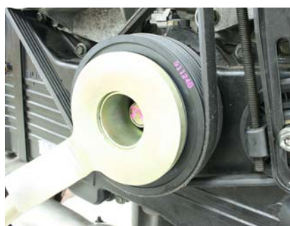
Verktøyet til veivakselen passer nøyaktig til OE-demperen
