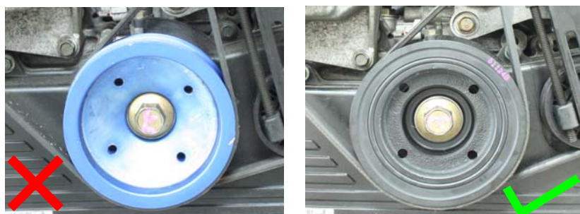
Ettermarkedets «power»-remskiver versus OE-demper for veivaksel
