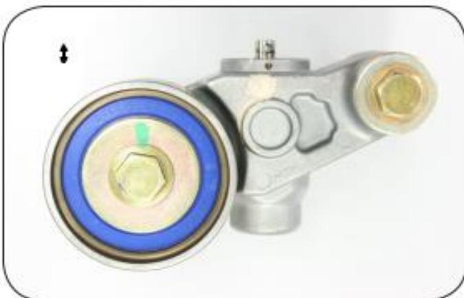
**Immagine 6:** Se l'estensione del pistone non è entro  $\pm 0,5$  mm di 5,7 mm - sostituire il tenditore
