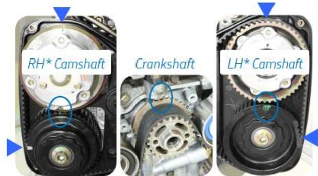
**Nota:** Con l'ammortizzatore rimosso - utilizzare l'attrezzo Subaru OE ST499987500 (adattatore per presa da ½") per girare l'albero motore.
