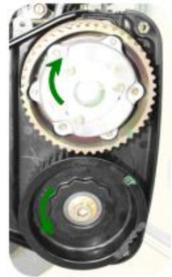
**Attenzione:** il corretto senso di rotazione degli alberi a camme LH per evitare interferenze tra le valvole del motore!
