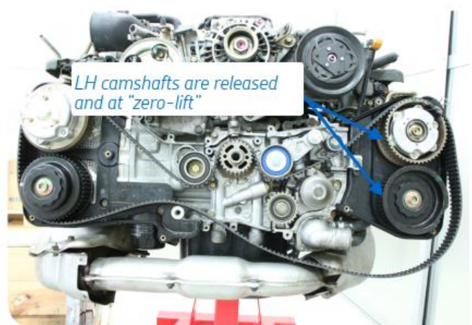
Obrázok 4: Napätie sa uvoľní, keď je demontované napínacie koleso A.
