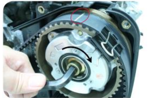
Obrázok 9: Zaistíte remeň sponou a zarovnajte na časovú značku
