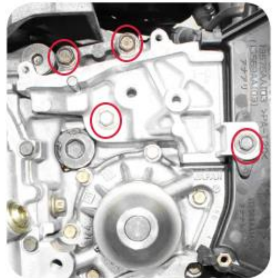
Obrázok 5: Skrutky zaisťujúce napínicu jednotku
