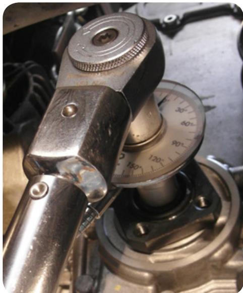
**Nota:** dado que los aprietes pueden ser distintos y altos, compruebe los pares de apriete específicos que recomiendan los fabricantes. El valor del par de apriete de cada marca puede variar, incluso si el diseño del motor es muy similar.
