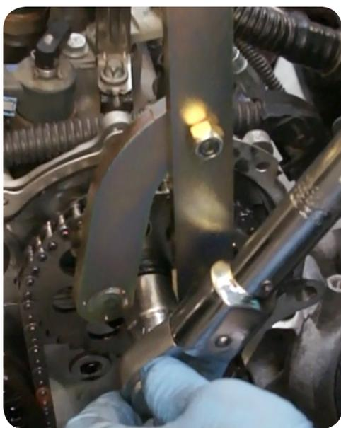
**Advertencia:** la polea dentada del árbol de levas no cuenta con una ranura principal entre el árbol de levas y la polea dentada. No utilice nunca una herramienta de bloqueo del árbol de levas para fijarlo cuando vaya a retirar el tornillo del árbol de levas. Las elevadas fuerzas aplicadas podrían romper la herramienta de bloqueo dentro del motor y dañar el árbol de levas.
