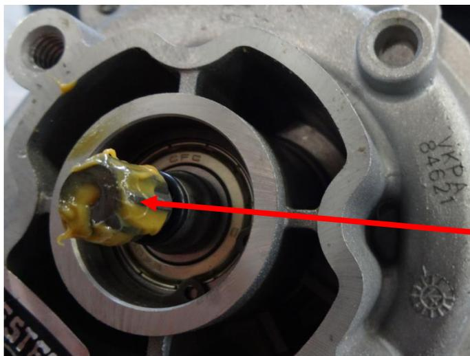
**Nota!** Compruebe siempre las condiciones de las chavetas. La principal causa del desgaste de las chavetas puede ser debido a las vibraciones del motor. Compruebe también las condiciones del amortiguador de cigueñal y del volante de inercia de doble masa.
