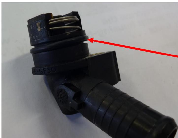
La junta tórica debe ajustarse correctamente para prevenir roces y vibraciones que pueden dañar la bomba de agua y el rotor.
