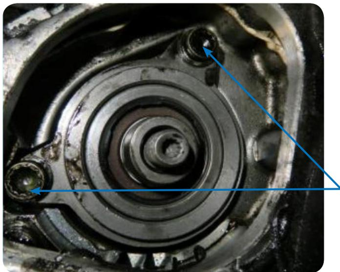
Una vez ajustada completamente a mano, apriete alternativamente los dos tornillos de retención, girándolos  $\frac{1}{4}$  de vuelta cada uno, hasta que la bomba este totalmente ajustada. Algunas veces puede que sea necesario golpear suavemente la tapa inferior para ayudar a que la bomba se ajuste plenamente.
