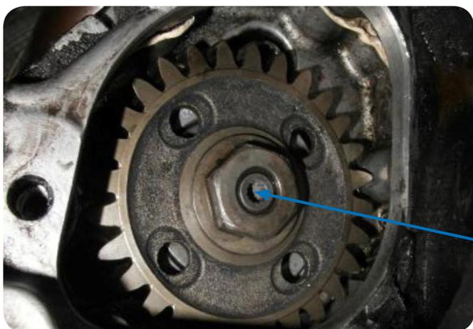
Vuelva a colocar el engranaje impulsor de la bomba de agua, y apretar a 84 Nm. Vuelva a llenar el sistema de refrigeración con una nueva y correcta mezcla de anticongelante.
