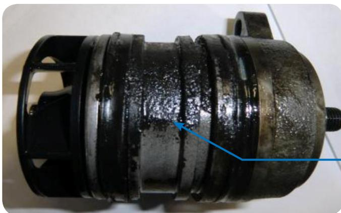
L'exemple montre les signes de fatigue du joint d'huile de la pompe démontée.
