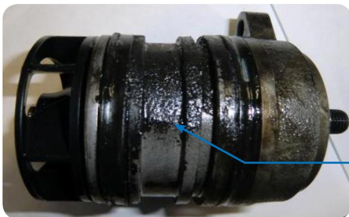
Exemplo de um colector usado que mostra sinais de falha no lado do vedante do óleo
