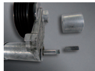
Puleggia alternatore a ruota libera - Misurazioni su un motore Diesel CR Daimler a 4 cilindri
