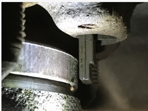
Abb. 2 Bremsscheibe und Sensor korrekt montiert
