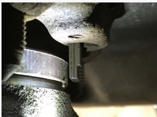
Fig. 2 Disco de travão e sensor corretamente instalados
