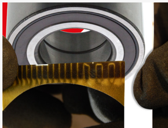
Beispiel eines fehlerhaften Polrads unter Verwendung einer magnetischen Testkarte
