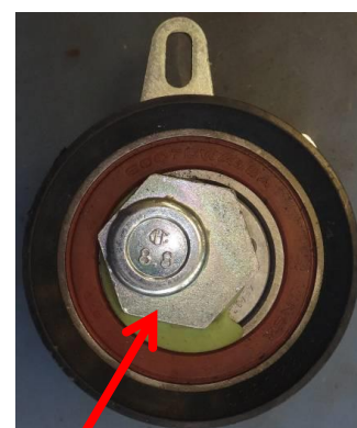
Rolle GT357.28 mit gebrochener Welle
