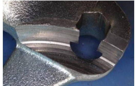
Abriebspuren durch Rollenkontakt
