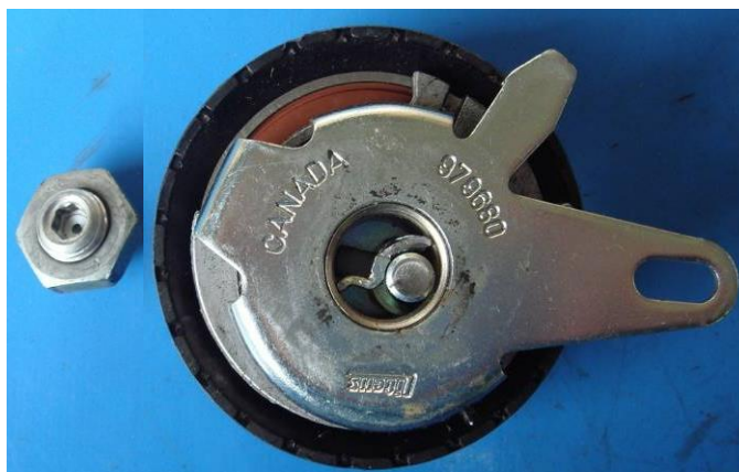
Rolle GT357.28 mit gebrochener Welle
