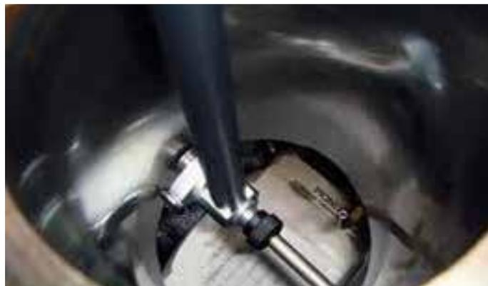
Cuando los cilindros del motor están rectificados, se procede a **pulir los cilindros** para que estos queden según la tolerancia que marca el fabricante, mediante el proceso de **esmerilado**.
