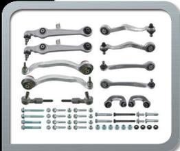
Vermeiden Sie Reklamationen, indem Sie die Befestigungsschrauben eines ausgewechselten Querlenkers unbedingt im eingefedertem Zustand anziehen! Das Anziehen der Schrauben im ausgefederten Zustand ist ein gravierender Montagefehler, der zur Überbeanspruchung der Gummilager führt. Dadurch können sich Risse bilden, die zum vorzeitigen Ausfall des Gummilagere führen. Die Achsgeometrie verändert sich und verursacht weitere Folgekosten (erhöhter Reifenverschleiß!).
