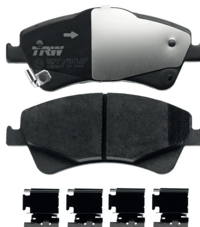
GDB3479 met mechanische slijtage-indicatie, regengroef, Shim (metaal en kunststof), pijl en individuele voeringgeleidingsplaten.
