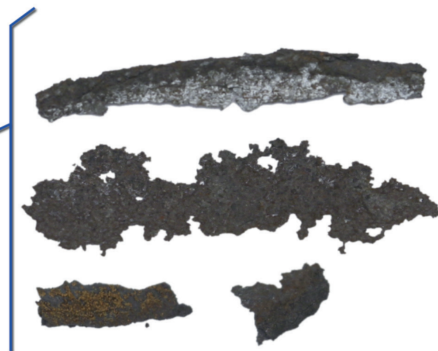
Zvětšené částčky koroze
