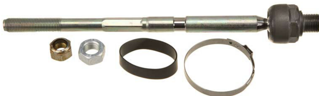
JAR957 - Limitação de esterçamento standard como série
