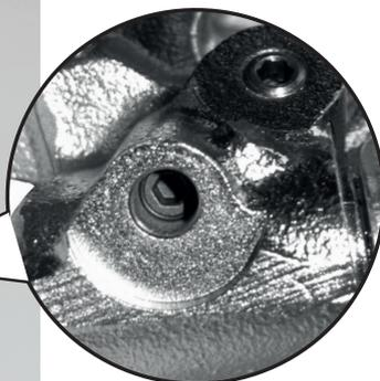
3. Затем повернуть регулировочный винт против часовой стрелки, чтобы диск вращался свободно.
