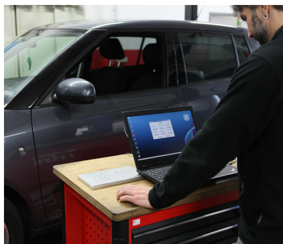
Obr. 2: Kódování čerpadla posilovače řízení
